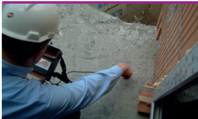
Badanie wilgotności płyty balkonowej – nie powinna przekraczać 7%.
