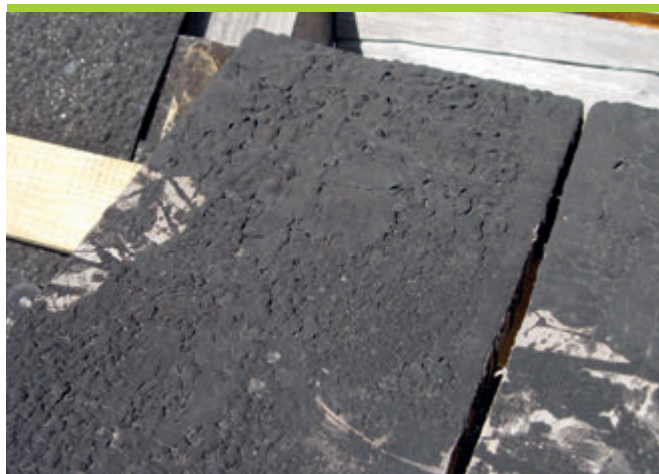
Niszczenie masy bitumicznej po nałożeniu na pokrycie smołowe.
