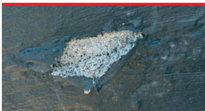
Izolacja o grubości znacznie cieńszej niż wymagana może nie osiągnąć wystarczającej wytrzymałości.
