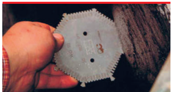
Pomiar grubości warstwy grzebieniem inspektorskim.
